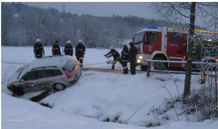
Wagenbach: Fahrzeugbergung mittels Greifzug
