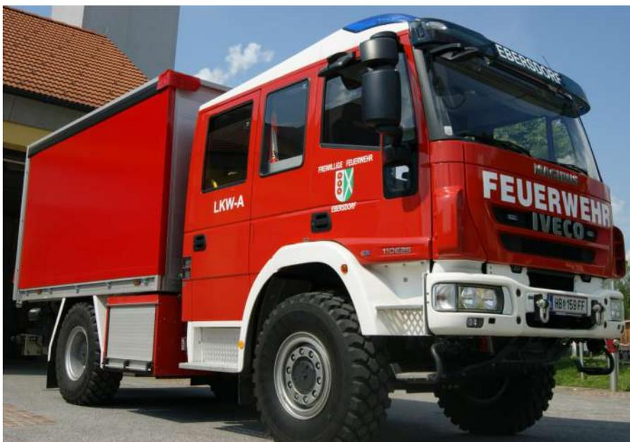
über eine Mannschaftskabine mit 1:8 Besatzung, einen Planenaufbau mit Rollcontainersystem, Ladebordwand, pneumatischem Lichtmast, Tragkraftspritze TS12, Notstromaggregat, Schmutzwasserpumpe etc. Dieses Fahrzeug ist neben Brandeinsätzen und technischen Einsätzen auch bei Katastropheneinsätzen und als Versorgungsfahrzeug einsetzbar.
